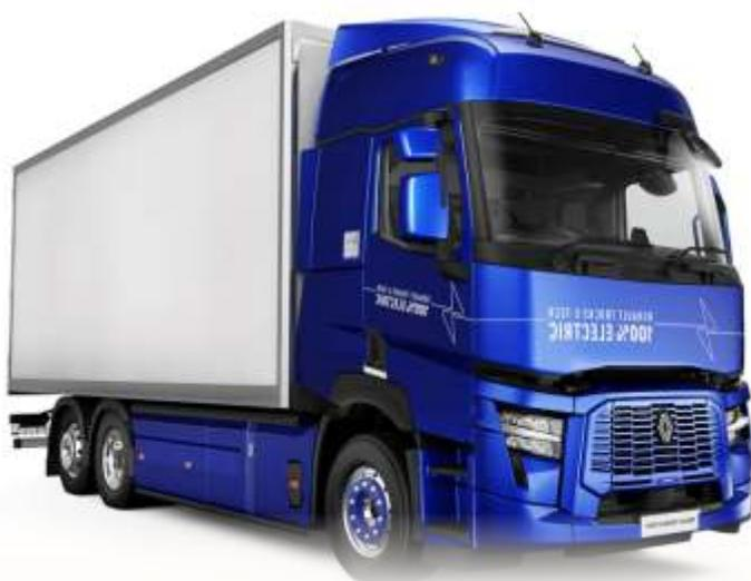
La mayor autonomía se debe a la introducción de una nueva tecnología llamada E-Achse, que permite concentrar todos los elementos del tren motriz en la parte trasera del vehículo, dejando más espacio para baterías adicionales. Renault Trucks espera que esta innovación, junto con la expansión de la infraestructura de carga pública, permita alcanzar la paridad operativa con la tecnología diésel.
