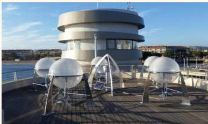
fuente de energía es un panel solar que alimenta la bomba que llena la esfera. El sistema se adapta a todo tipo de cursos de agua constituidos por agua no potable (mares, lagos, ríos, estanques). Cada esfera puede producir hasta 10 litros de agua al día, lo que equivale a las necesidades de agua potable de una familia de cinco personas. Tiene una vida útil mínima de 30 años.
