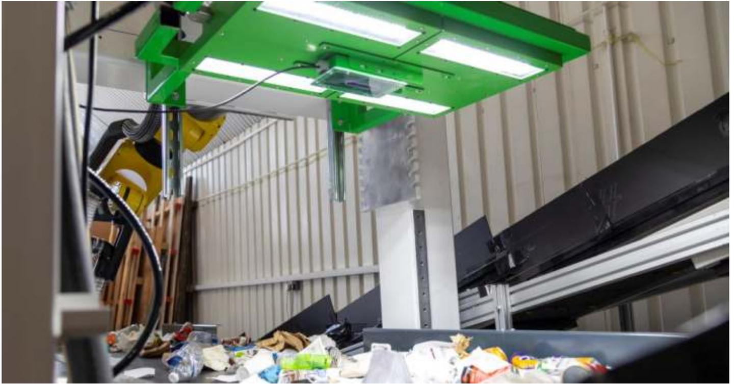
para ser instalado durante el primer semestre de 2024. Esta tecnología, proporcionada por Recycleye, utiliza visión computarizada para detectar y clasificar automáticamente los residuos, marcando un hito en la innovación en gestión de residuos en España.
